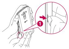
2 Deslice la tarjeta micro-SIM en la ranura inferior para tarjeta micro-SIM como se muestra en la imagen. Asegúrese de que el área de contacto dorada de la tarjeta quede hacia abajo.
