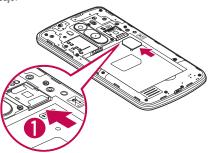
3 Inserte la batería en su lugar alineando los contactos dorados del teléfono y la batería (1) y presione la batería hacia abajo hasta escuchar un clic (2).
