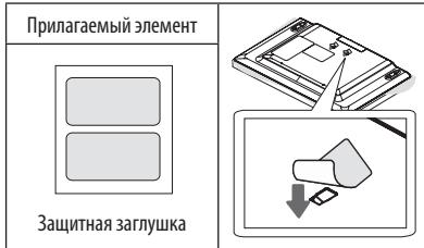
• При креплении телевизора к кронштейну для настенного крепления другого производителя вставьте фигурные шайбы настенного крепления в отверстия для крепления телевизора к стене для сохранения его вертикального положения. (Только если предоставлен элемент, приведенный в следующей форме)
