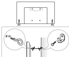
1 Вставьте и затяните болты с ушками или болты кронштейнов TB на задней панели телевизора.
