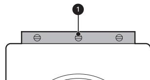
**3** Bevestig de instelvoeten met de borgmoeren ② door ze linksom te draaien tegen de onderzijde van het apparaat.
