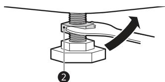
**4** Controleer of alle moeren onderaan op het apparaat stevig zijn aangebracht.
