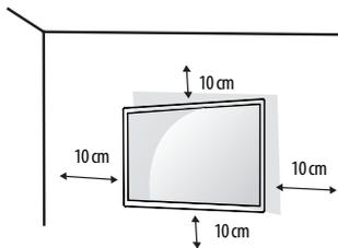
Ako televizor želite montirati na zid, priključite sučelje za montiranje na zid (dodatni dijelovi) na stražnji dio televizora.
