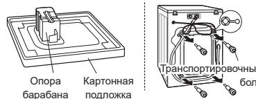
Снимите транспортировочные болты и опоры.
