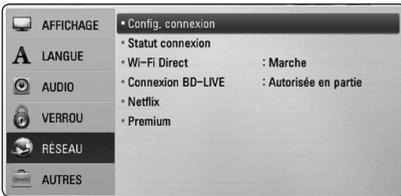
2. Le menu [Config. connexion] apparaît à l'écran. Utilisez les touches  $\wedge$  /  $\vee$  pour sélectionner [Câblé], puis appuyez sur ENTER (⊙).
