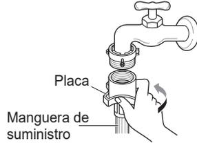
**Conexión de la manguera a presión con el grifo sin rosca**
