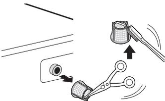
Laisser l'eau refroidir avant de nettoyer le filtre de la pompe de vidange. Ouvrir la porte en cas d'urgence ou effectuer une évacuation d'urgence.
