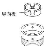
3 将接头往上推至水龙头末端, 从而使橡胶密封圈形成水密连接。拧紧四颗固定螺丝。
