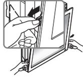
3. Poussez et fermez la partie supérieure du panneau avant et puis tirez en avant la partie inférieure du panneau jusqu'à ce qu'il soit fixé.
