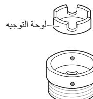
**3** ادفع المحول إلى طرف الصنبور بحيث تتشكل الحشية المطاطية وصلة منيعة للماء. أحكم ربط مسامير التثبيت الأربع ولوحة الحلقة للمحول.
