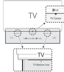
2. Verwenden Sie zur Wandmontage (Beton) die Dübel. Zur Montage müssen einige Löcher in die Wand gebohrt werden. Eine Montageschablone (Montageschablone der Wandhalterung) für die Bohrungen ist im Lieferumfang enthalten. Nehmen Sie anhand der Schablone die Bohrungen vor.
