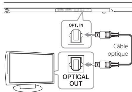
2. Réglez la source d'entrée sur OPTICAL. Appuyez plusieurs fois sur la touche **FUNCTION** de la télécommande ou sur la touche **F** de l'unité jusqu'à ce que la fonction souhaitée soit sélectionnée.
