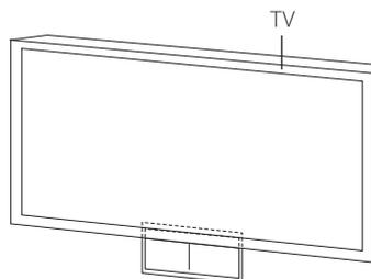
2. Si vous fixez la barre de son sur un mur en béton, utilisez des chevilles. Vous devrez percer quelques trous. Un gabarit (Guide d'installation des supports muraux) est fourni pour vous y aider. Utilisez-le pour repérer les endroits où vous devez percer.
