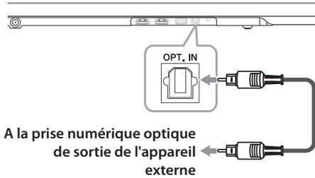
A la prise numérique optique de sortie de l'appareil externe
