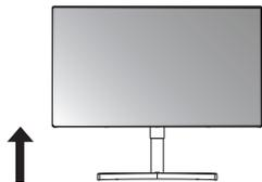
2 図に示したように、矢印の方向にモニターの角度を調整します。
