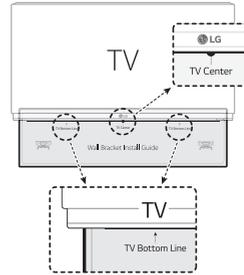
2. Para el montaje mural (hormigón), utilice taquetes de pared. Deberá taladrar algunos orificios. Se suministra una ficha guía (Guía de instalación de los soportes de pared) para taladrar. Use dicha guía para verificar el punto a taladrar.
