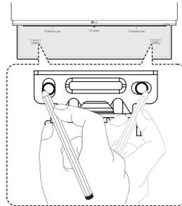
3. Retire la guía de instalación del soporte de pared.
