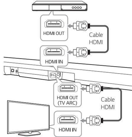
1. Conecte el conector HDMI IN en la parte posterior de la unidad al conector HDMI OUT del dispositivo externo, tal como reproductor de discos Blu-ray, DVD, etc.
