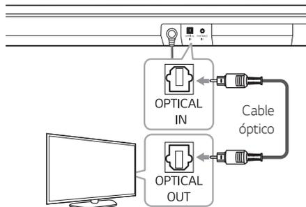
2. Seleccione la fuente de entrada en OPT/HDMI ARC pulsando **F** repetidamente en el control remoto o la unidad.
