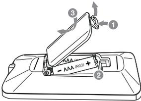
Retire la cubierta de la batería de la parte trasera del control remoto, e introduzca batería (tamaño AAA) de 1,5 Vcc con  $\oplus$  y  $\ominus$  colocados correctamente.
