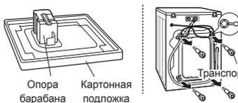
Снимите транспортировочные болты и опоры.
