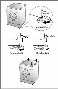
1. Mengatur tinggi mesin cuci yang tepat dapat mencegah mesin bergetar dan mengeluarkan suara berisik yang berlebihan. Tempatkan mesin pada permukaan lantai yang kokoh dan tepat. Pojok ruangan adalah tempat yang sesuai untuk meletakkannya.
