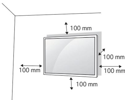
Para instalar o seu monitor numa parede, fixe um suporte de montagem na parede (peça opcional) na parte posterior do monitor.
