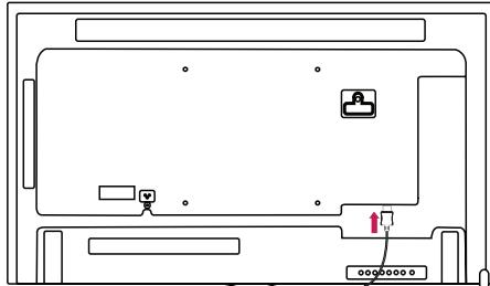
2 Στερεώστε τα ηχεία με τις βίδες, όπως φαίνεται παρακάτω. Πριν από τη σύνδεση, βεβαιωθείτε ότι το καλώδιο τροφοδοσίας είναι αποσυνδεδεμένο.
