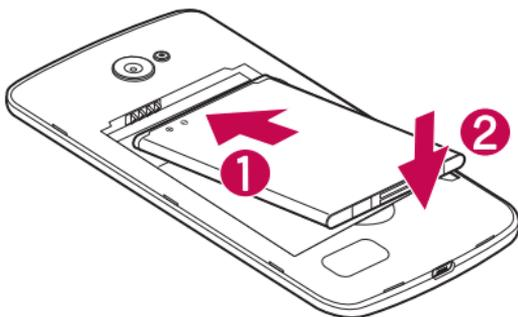
**4** Per inserire nuovamente la cover sul telefono, allineare la cover posteriore allo slot della batteria **1** e premerla fino a farla scattare in posizione **2**.
