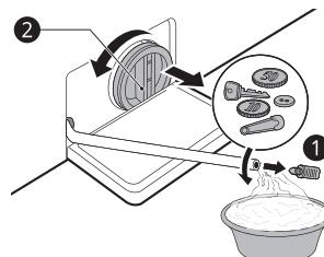
**4** Після очищення фільтра зливного насоса вийміть фільтр і закрійте зливний шланг заглушкою.
