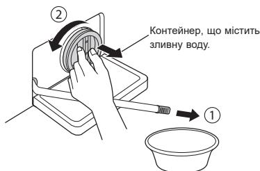
**3** Дістаньте з фільтра зливного насоса всі сторонні предмети.
