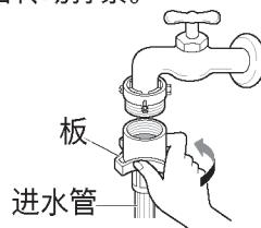
**将一根接触式软管连接至无螺纹水龙头**
