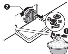
4 清理完排水泵过滤器后，取出排水泵过滤器并插入排水塞。
