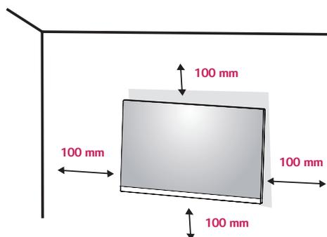
Si instala el monitor en una pared, fije un soporte de montaje en pared (opcional) en la parte trasera del monitor.
