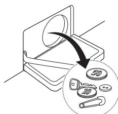
**4** Після очистки вставте фільтр на місце та закрійте зливний шланг заглушкою.
