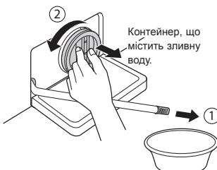
**3** Дістаньте з фільтра зливного насоса всі сторонні предмети.
