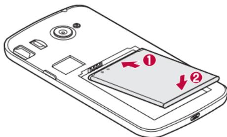
4 Para volver a colocar la tapa en el dispositivo, alinee la tapa posterior con el compartimento de la batería y presiónela hasta que encaje en su sitio.
