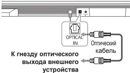
1. Соедините разъем OPTICAL IN на задней панели устройства и оптический выход вашего ТВ (или цифрового устройства и т.д.)
