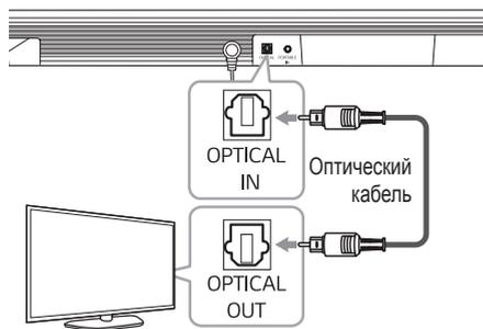
2. Установите вывод звука на ТВ для прослушивания звуковых файлов с помощью данного устройства :
