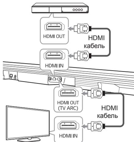
1. Подключите разъем HDMI IN с задней стороны установки к разъему HDMI OUT таких внешних устройств, как проигрыватель Blu-ray, проигрыватель DVD и т. д.
