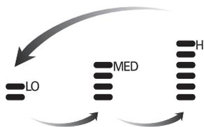
Selección de velocidad de ventilador en Calor, Deshumidificación, Ventilador, Funcionamiento automático
