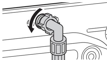
**2** Retire el filtro de entrada de agua con pinzas pequeñas y luego limpie el filtro utilizando un cepillo de diente de cerdas medianas.
