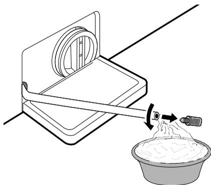
**4** Desatornille el filtro de la bomba de drenaje lentamente para vaciar el agua restante y luego proceda a eliminar cualesquiera residuos u objetos del filtro.
