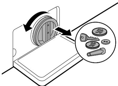
**5** Después de la limpieza del filtro de la bomba de drenaje, reinserte cuidadosamente el filtro y atornille la tapa de drenaje en el sentido de las agujas del reloj con cuidado para evitar daños a la rosca y fugas. Reinserte el tapón en el tubo de drenaje y coloque el tubo en su soporte.
