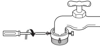
4 Presione la manguera de entrada ④ verticalmente hacia arriba de modo que el sello de goma de la manguera pueda adherirse completamente al grifo y luego ajústela girando la rosca hacia la derecha.
