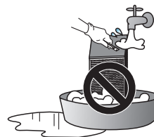
Nettoyage de l'échangeur thermique total
