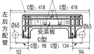
装置轮廓线 在突耳上放置一个水平仪
