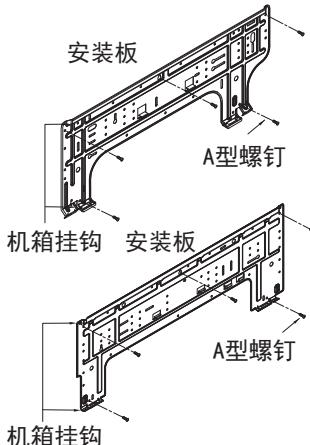
2 测量墙的尺寸并标记中心线。特别要注意安装板的位置。通常是从墙体布线至电源插座。在墙体上打孔进行配管连接时必须安全进行。
