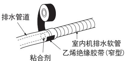
在连接部位缠绕绝缘材料。
