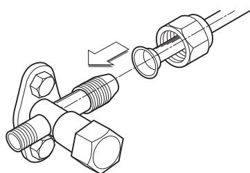
3 最后，使用扭矩扳手紧固扩口螺母，直到扳手发出咔哒声。
