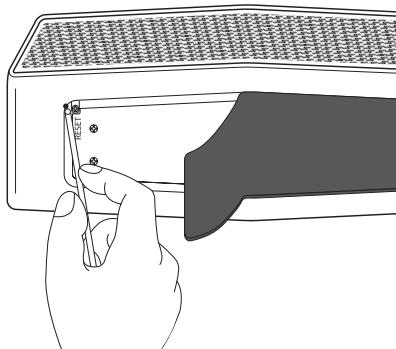
В случае "зависания" устройства при неправильном функционировании, удалите резиновую прокладку и надавите на отверстие с помощью какого-либо объекта типа булавки. После этого устройство отключится полностью.
