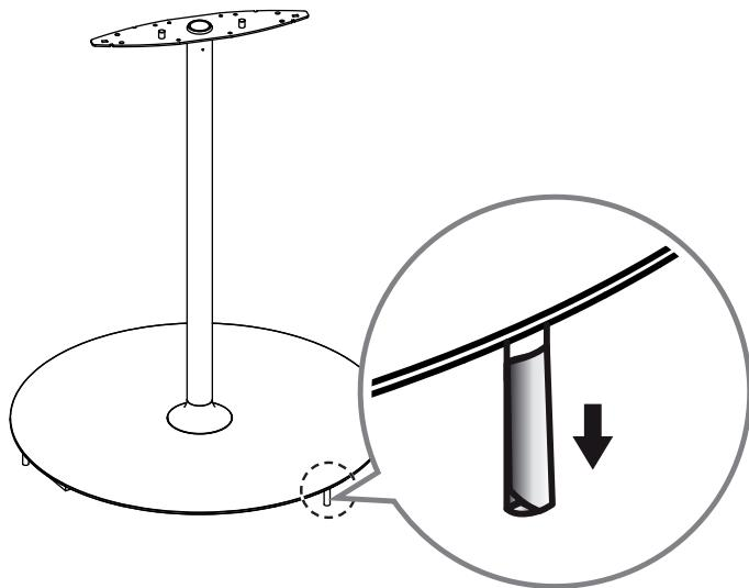
7 Cylinder Stand Top, 사이니지 박스와 Stand Bottom은 바닥에 나란히 정렬한 후 16/22핀 케이블과 HDMI 케이블은 상측 프레임 홀에서부터 아래 수직방향으로 삽입하여 동과시킵니다.
