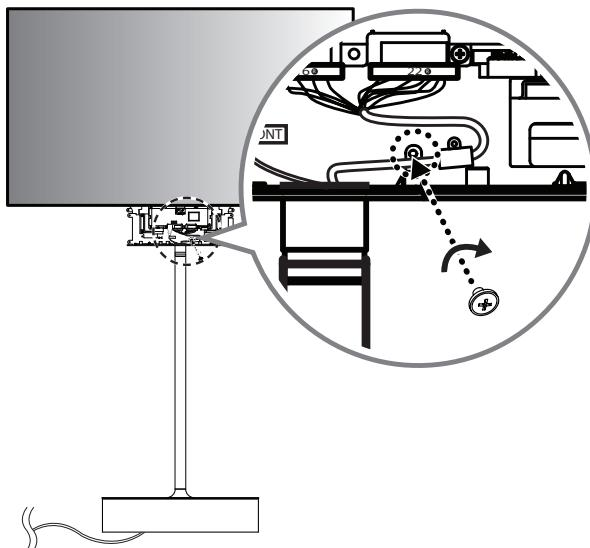
17 FRONT 라벨이 없는 HDMI 케이블은 Rear 면에 연결합니다. 붉은색 표시가 있는 16/22 pin 케이블을 홀더를 끼우고 나사(M3 x L4.5)를 이용해 조립한 후 연결합니다.
