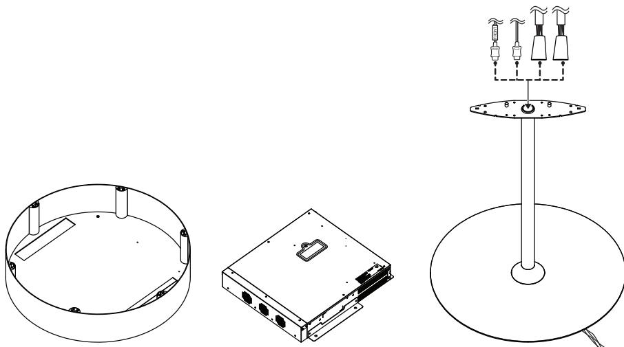
8 사이니지 박스에 파이프를 동과시킨 케이블은 연결합니다. 이때 Front 케이블은 위에, Rear 케이블은 아래에 체결합니다. 16/22 pin 케이블의 경우 붉은색 표시가 있는 케이블은 위에 체결합니다.
