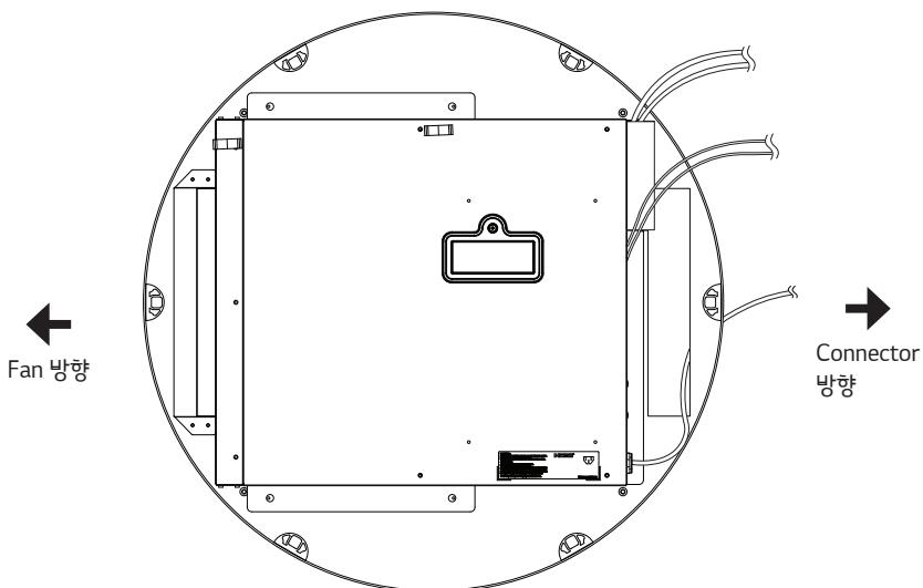
13 스탠드베이스에 케이블이 체결된 사이니지 박스를 설치하고, 나사(M3 x L4.5) 4개를 이용하여 고정합니다.
