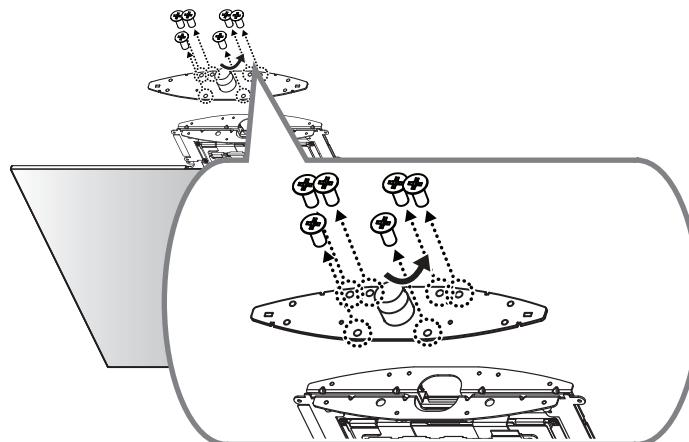
4 Cylinder Stand Top에 파이프를 조립하고, 파이프에 프레임은 조립합니다. 그리고 파이프를 잡고 Cylinder Stand Top은 개봉합니다.
