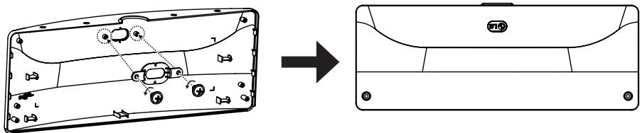
19 T-con 박스의 IR 수신부가 있는 면을 Front 면에 덮고, 반대쪽에서 나사( $\Phi 3 \times L6$ ) 4개도 체결합니다.
