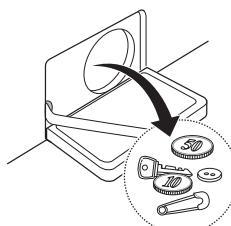
4 Après nettoyage, tourner le filtre de la pompe et insérer le bouchon de vidange.
