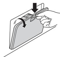
2 Ouvrir le bouchon de vidange et ouvrir le filtre en le tournant vers la gauche.
