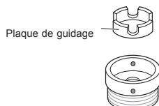
3 Pousser l'adaptateur dans l'extrémité du robinet afin que le joint en caoutchouc forme une liaison étanche. Serrer les quatre vis de fixation.
