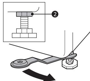
**4** Verifique si todas las tuercas de seguridad de la parte inferior de el electrodoméstico están aseguradas correctamente.
