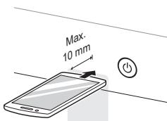
**3** Pulse y mantenga presionado el botón **Temp.** durante 3 segundos o más mientras sostiene el micrófono del teléfono inteligente junto al botón **Encendido/Apagado** hasta que la transferencia de datos finalice.
