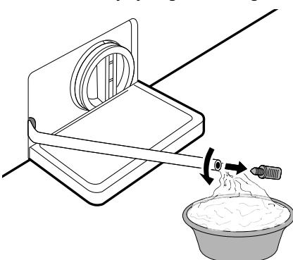
5 Después de la limpieza del filtro de la bomba de drenaje, reinserте cuidadosamente el filtro y atornille la tapa de drenaje en el sentido de las agujas del reloj con cuidado para evitar daños a la rosca y fugas. Reinserte el tapón en el tubo de drenaje y coloque el tubo en su soporte.
