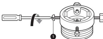
3 Presione el adaptador contra el extremo del grifo de modo que el sello de goma forme una conexión hermética. Ajuste los 4 tornillos de fijación.
