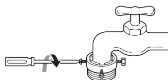
4 Presione la manguera de entrada ③ verticalmente hacia arriba de modo que el sello de goma de la manguera pueda adherirse completamente al grifo y luego ajústela girando la rosca hacia la derecha.
