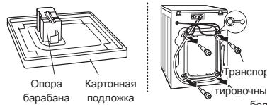
Снимите транспортировочные болты и опоры.
