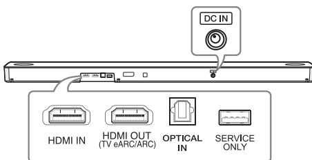
DC IN ····· Подключение сетевого блока питания.
