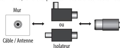
Connectez l'une des extrémités de l'isolateur au câble ou à la prise de l'antenne et l'autre extrémité au moniteur ou au décodeur.
