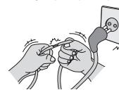
Protégez le cordon d'alimentation contre les mauvais traitements physiques ou mécaniques, la torsion, la pliure, le pincement, et évitez qu'il ne puisse être pris dans une porte ou que l'on puisse marcher dessus. Vérifiez soigneusement les fiches, les prises murales et les points de sortie du cordon de l'appareil.
