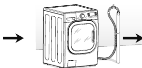
Raccordement de la conduite d'évacuation
