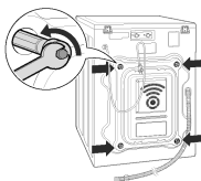
Déballage et retrait des boulons d'expédition
