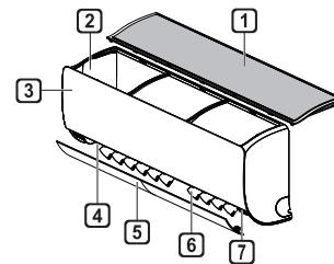
فتحات دخول الهواء **1**فتحات خروج الهواء **2**فلتر الهواء **1**مدخل الهواء **2**غطاء أمامي **3**مخرج الهواء **4**عاكس الهواء (ريشة أفقية) **5**عاكس الهواء (فتحة تهوية عمودية) **6**زر تشغيل/إيقاف التشغيل **7**
