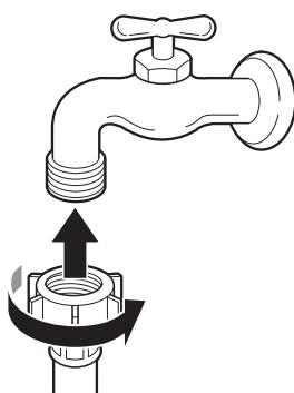
**将一根接触式软管连接至螺纹型水龙头**
