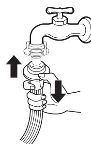
**将螺纹式软管连接到无螺纹水龙头。**
