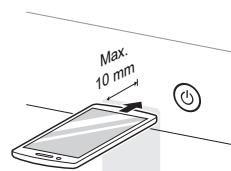
**3** 按住 **温度** 按钮 3 秒或更长时间，同时将智能手机麦克风保持在靠近 **电源** 按钮的地方，直至完成数据传输。
