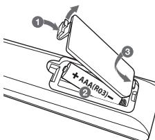
Retirez le couvercle du compartiment de la pile à l'arrière de la télécommande, puis insérez la pile en respectant la polarité + et -.
