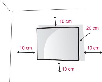
Instale el monitor a una distancia mínima de 20 cm de la pared y deje unos 10 cm de espacio en cada lado del monitor para permitir una ventilación adecuada.
