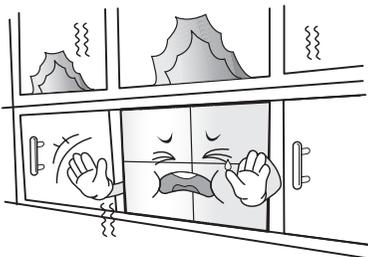
No instale el producto en un lugar sin ventilación (por ejemplo, en un estante o en un armario) ni sobre una alfombra o un cojín. Si no tiene más alternativa que montar el producto en la pared, asegúrese de que existe la suficiente ventilación antes de la instalación.
