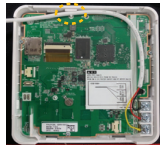
Retén central superior para fijar el cable doblado
