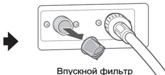
Очистите фильтр клапана впуска воды или переустановите шланги подачи воды.
