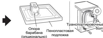
Снимите транспортировочные болты и опоры.
