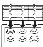
**NO** colocar aluminio sobre superficie de cocción, haciendo esto puede causar daño sobre la superficie de acero inoxidable.
