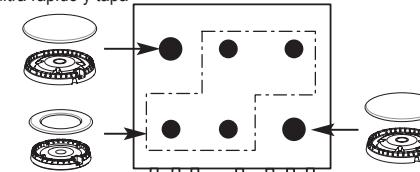
cabezal de quemador rápido y tapa
