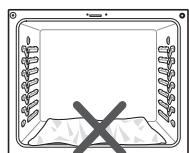
**NO** colocar aluminio al interior del horno, puede dañar acabado de interior esmaltado.
