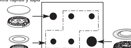
cabezal de quemador rápido y tapa
