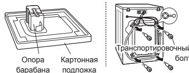
Снимите транспортировочные болты и опоры.
