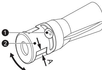
**3** Ajuste el obturador de aire al tamaño 'A', apriete el tornillo **1**.
