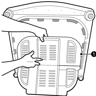
**3** Inserte los 2 tornillos **②** en los agujeros para ensamblar la cubierta anti-ratas en el electrodoméstico.
