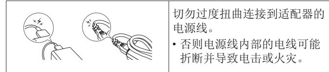
切勿过度扭曲连接到适配器的电源线。
